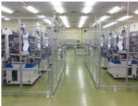
SANKYO三和工場では12台の「釘整備ロボット」が稼働している。
