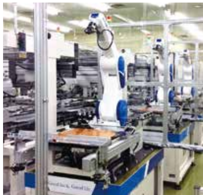
SANKYOと宮山技術研究所が共同開発した 「全自動釘整備システム」。
